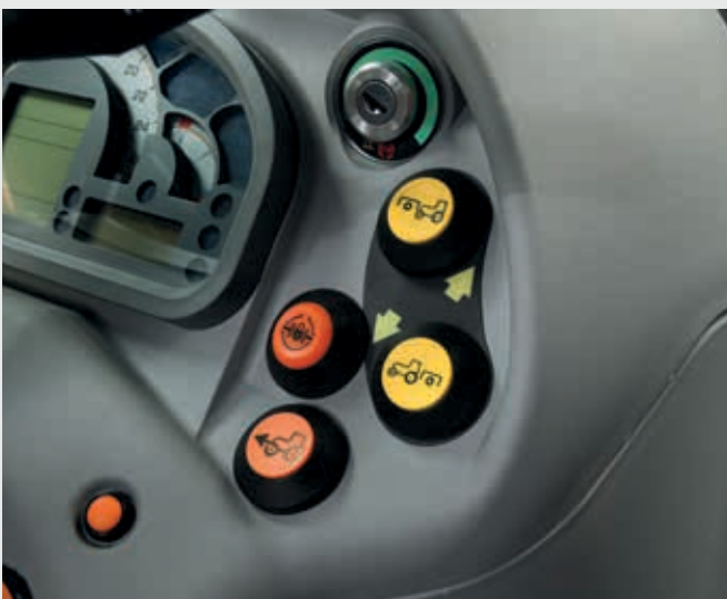
↑ Eenvoudige inschakeling van PTO voor en achter door middel van ergonomische knoppen.
