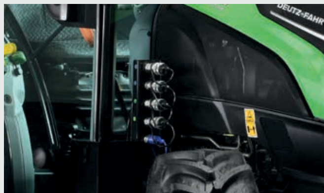
↑ Tot 4 hydraulische centraal gemonteerde leidingen en 1 vrije retour.
