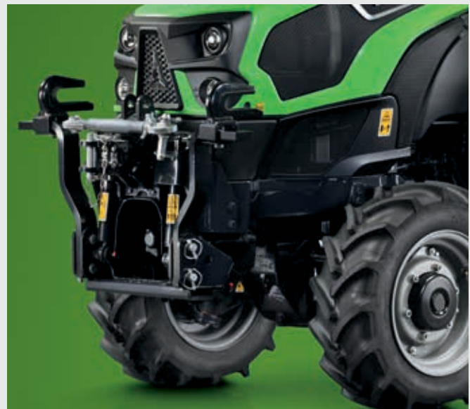
↑ Volledig geïntegreerde hefinrichting en PTO voor.
