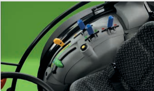
⬆ Eenvoudige en effectieve mechanische bediening van de hefinrichting achter.
