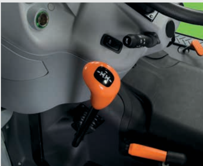
⬆ Mechanische pendelhefboom op stuurkolom.
