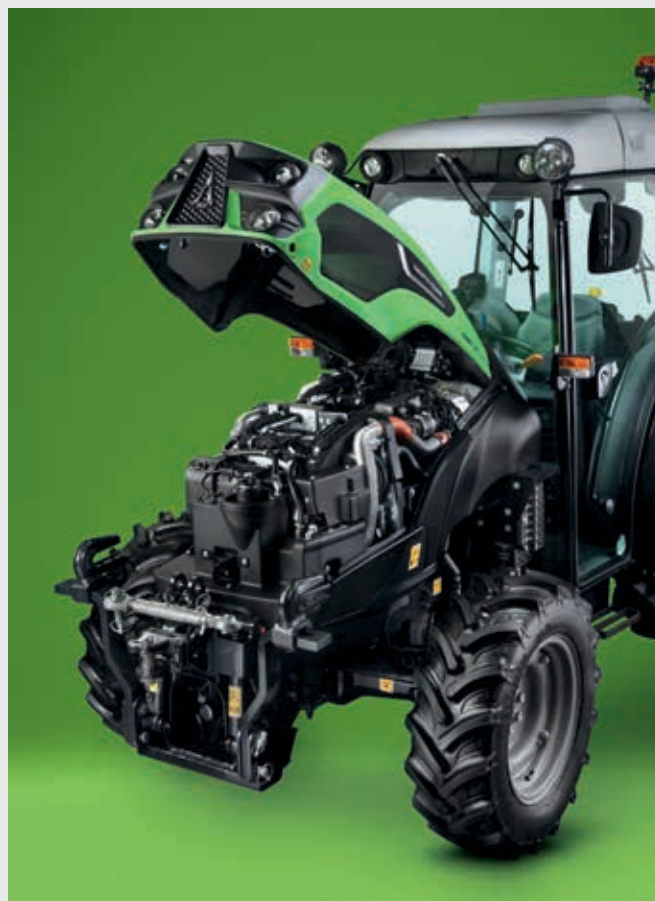
↑ In overeenstemming met Stage V door middel van een eenvoudig EAT-systeem. AdBlue niet vereist.
