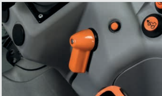
↑ Elektronische motorbesturingseenheid met één motortoerental in het geheugen.
