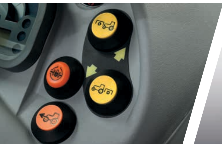
> Engate fácil da TDF dianteira e traseira com botões ergonômicos.
