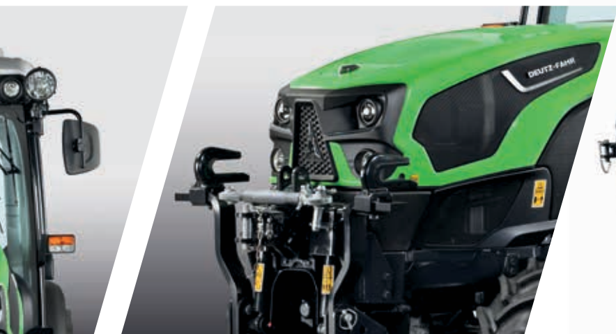
> Elevador frontal e TDF frontal totalmente integrados.
