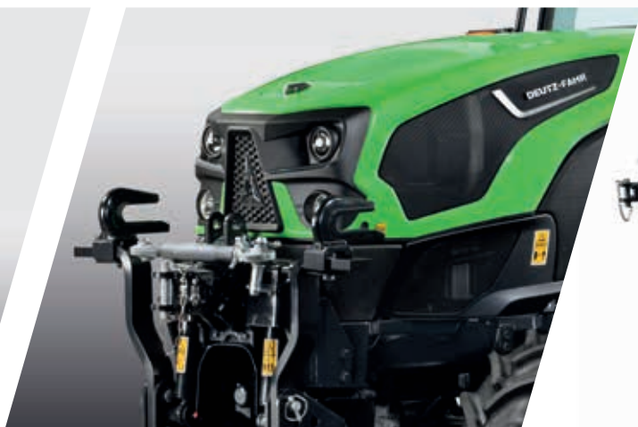
> Elevador frontal e TDF frontal totalmente integrados.
