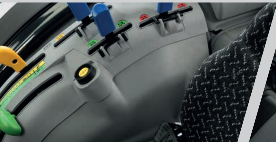
> Controlo mecânico simples e eficaz do elevador traseiro..
