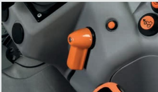
↑ Regulação eletrônica do motor com uma velocidade de memória do motor.
