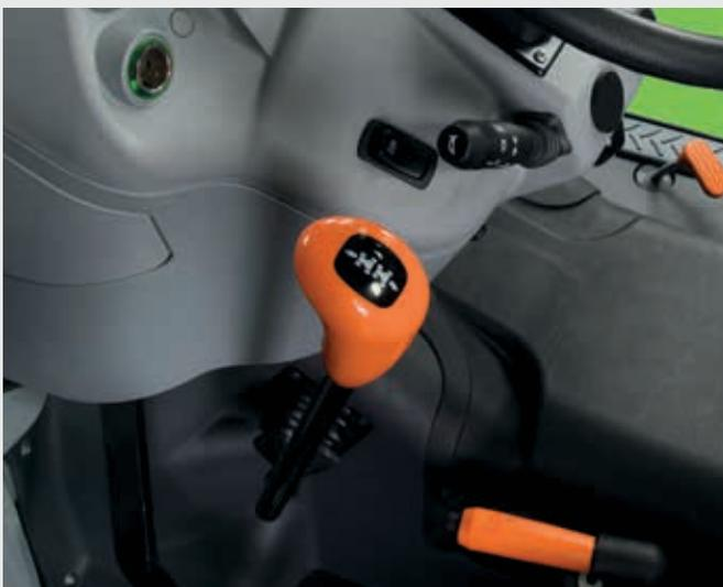
↑ Alavanca do inversor mecânico na coluna de direção.
