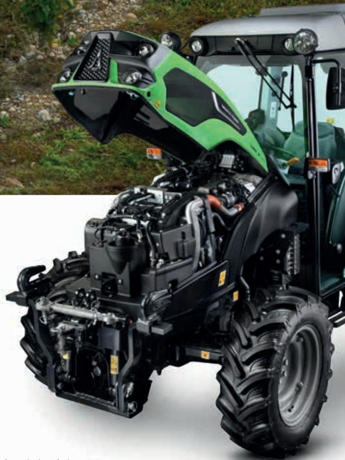
> Stage-V-konform dank einfachem EAT-System Kein AdBlue erforderlich.
