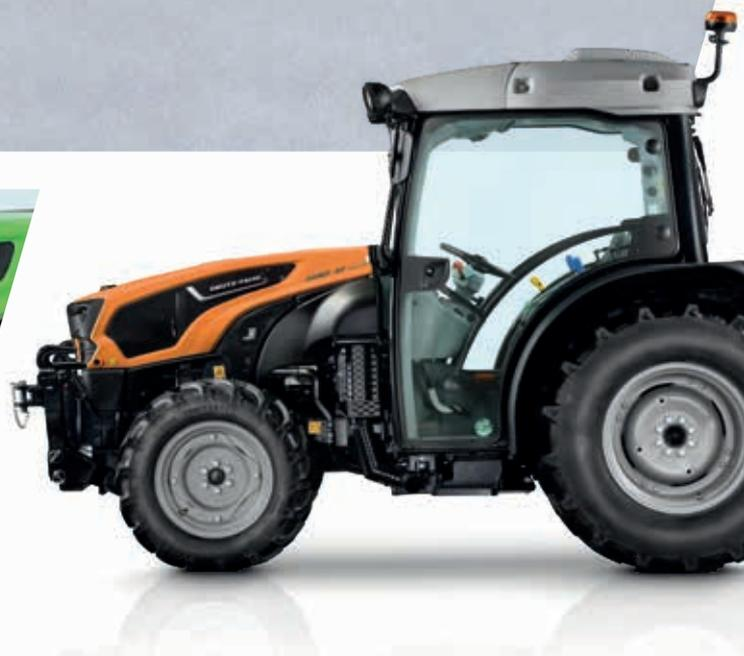
> Frontkraftheber und Frontzapfwelle vollständig integriert.
