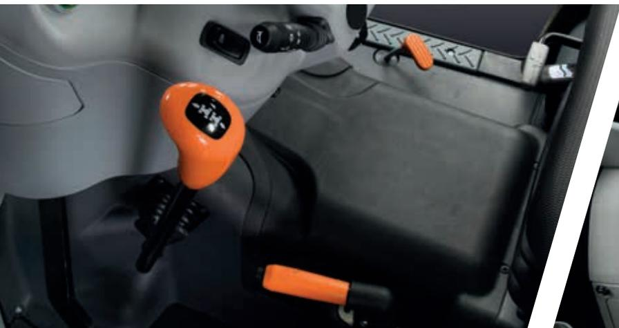
> Mechanischer Wendeschalthebel an der Lenksäule.
