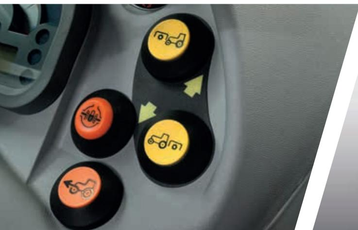
> Einfaches Einschalten der Front- und Heckzapfwelle durch ergonomische Tasten.
