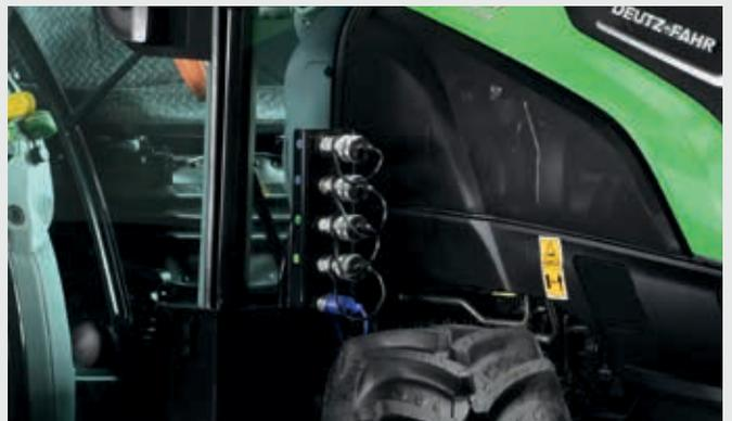
↑ Bis zu 4 hydraulische Zwischenachswwege und 1 druckloser Rücklauf.
