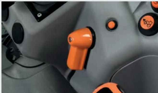
↑ Elektronischer Motordrehzahlregler mit einer gespeicherten Motordrehzahl.
