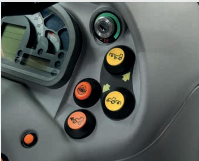
↑ Einfaches Einschalten der Front- und Heck PTO durch ergonomische Tasten.
