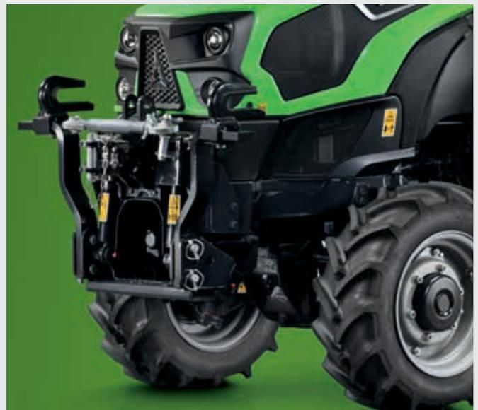
↑ Frontkraftheber und Front PTO voll eingebaut.
