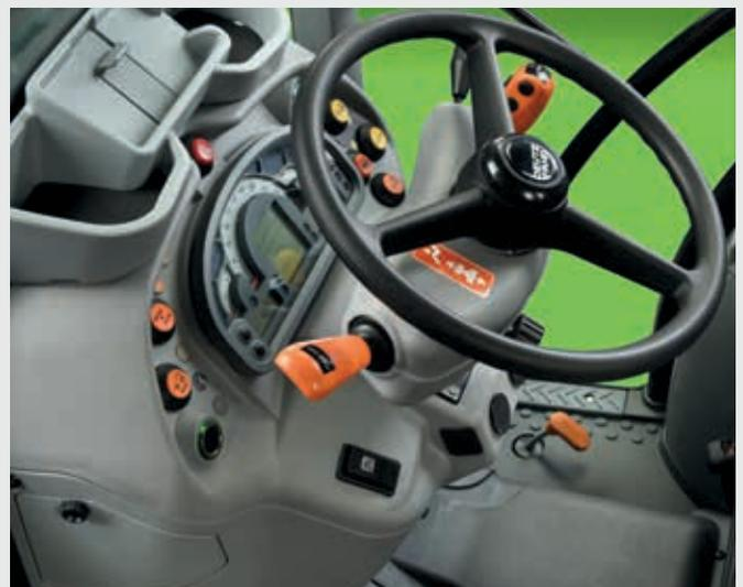
⬆ PowerShuttle sowohl bei der Kabinenausführung als auch der Version mit Überrollbügel verfügbar.
