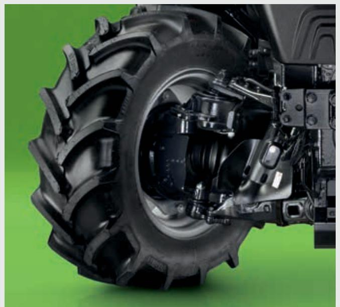
↑ Einzelradgedeferte Vorderachse bei allen Modellen vorhanden.
