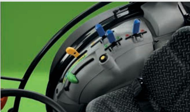
↑ Einfacher und effektiver mechanischer Heckkraftheber.
