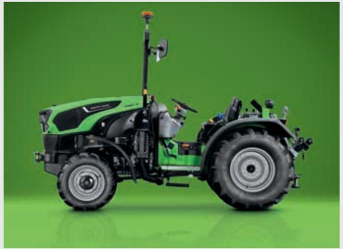
↑ Alle Modelle sind als Plattformversion mit klappbaren 2-Pfosten Überrollbügel erhältlich.
