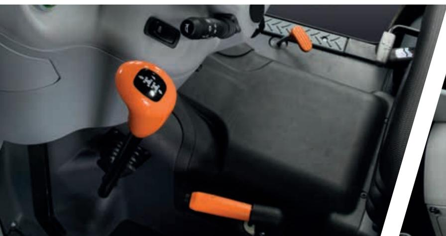
> Palanca del inversor mecánico en la columna de dirección.
