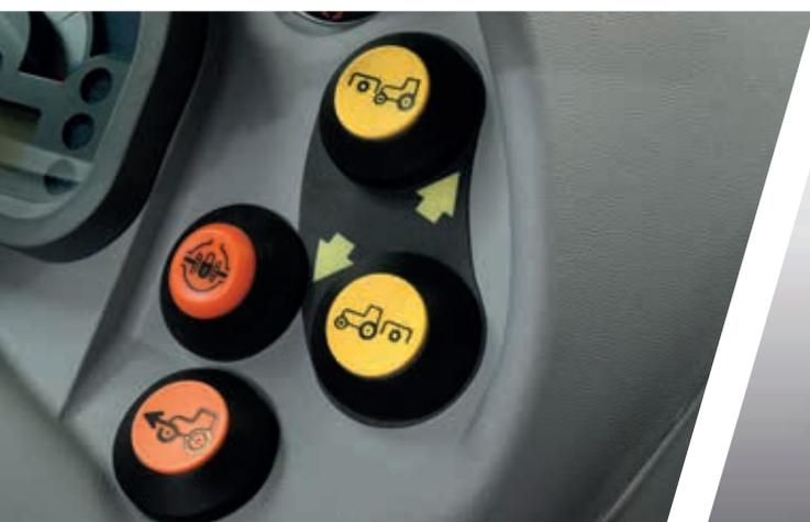
> Fácil accionamiento de la TDF delantera y trasera mediante botones ergonómicos.
