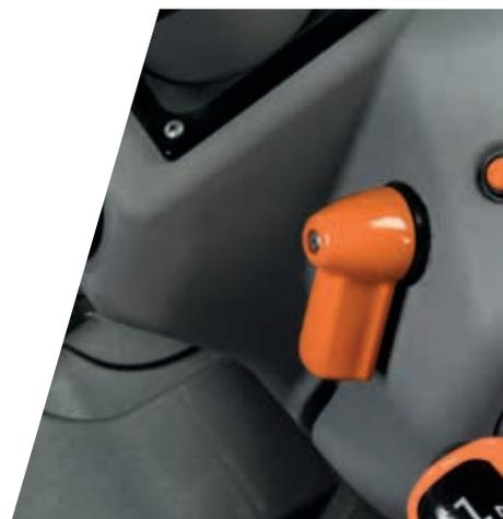
> Regulador electrónico del motor con una velocidad de motor.
