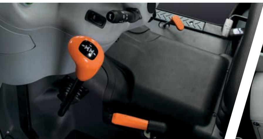
> Levier d'inverseur mécanique sur la colonne de direction.
