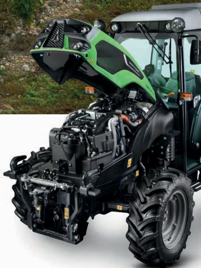
> Conformité au Stage V grâce à un simple système EAT. AdBlue non nécessaire.
