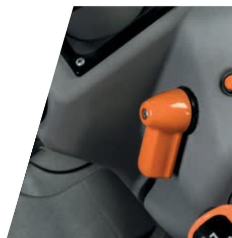
> Régulateur électronique de moteur avec une vitesse de rotation réglable.
