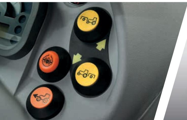
> Engagement facile de la prise de force avant et arrière grâce à des boutons ergonomiques.
