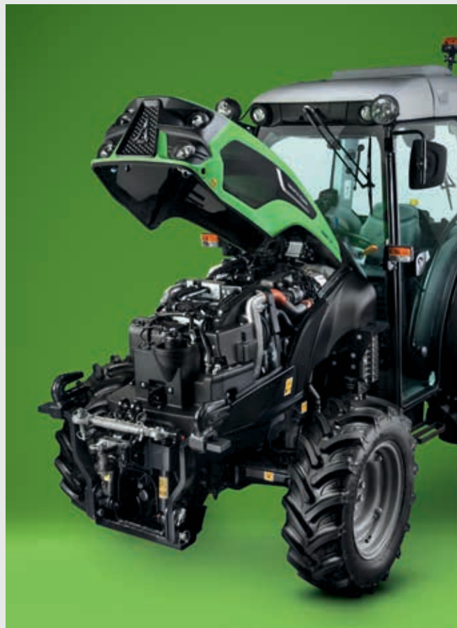
↑ Conforme à la norme Stage V grâce à un simple système EAT. AdBlue non requis.
