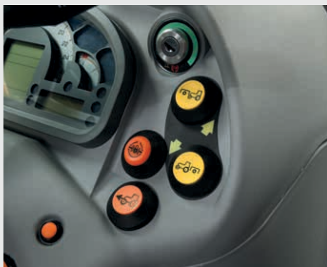
Engagement facile de la PDF avant et arrière grâce aux boutons ergonomiques.
