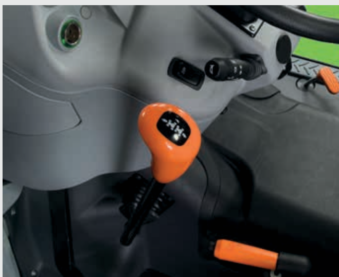
↑ Levier d'inverseur mécanique sur la colonne de direction.
