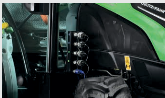
↑ Jusqu'à 4 voies hydrauliques centrales et 1 vidange libre.
