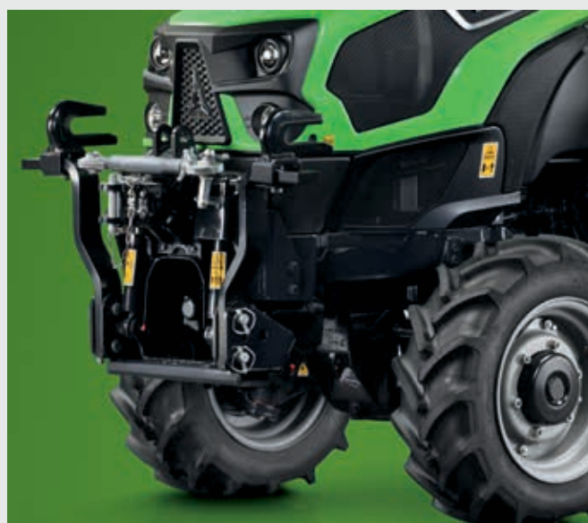
↑ Relevage avant et PDF avant entièrement intégrés.
