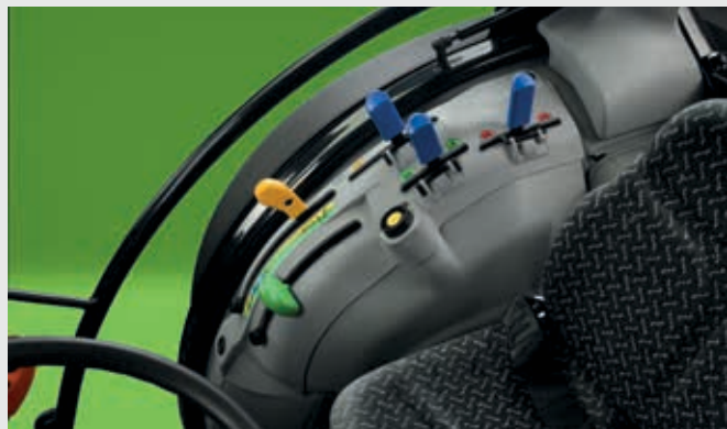
↑ Commande de relevage arrière mécanique simple et efficace.
