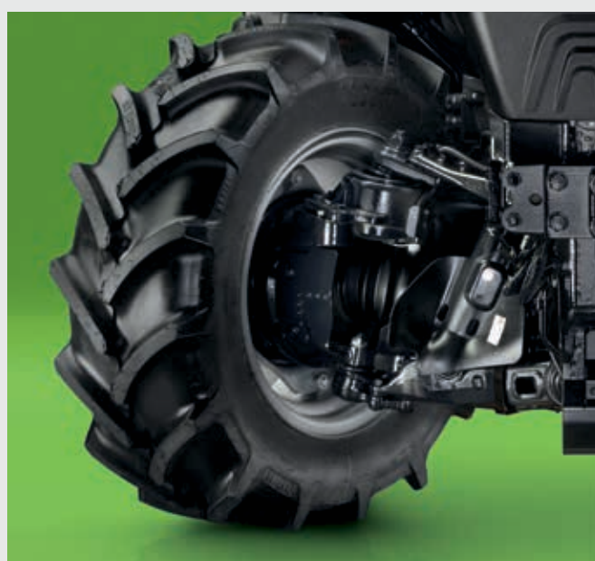
↑ Suspension de pont avant à roues indépendantes disponible sur tous les modèles.
