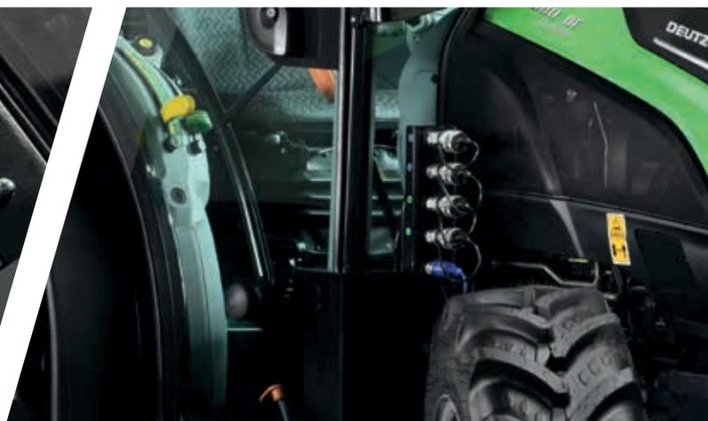
> Fino a 4 distributori idraulici ventrali e 1 scarico libero.
