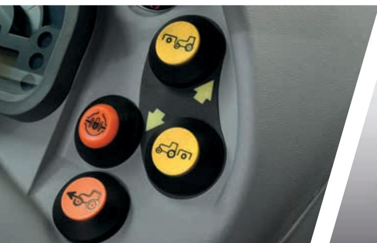
> Facile innesto della PTO anteriore e posteriore tramite pulsanti ergonomici.
