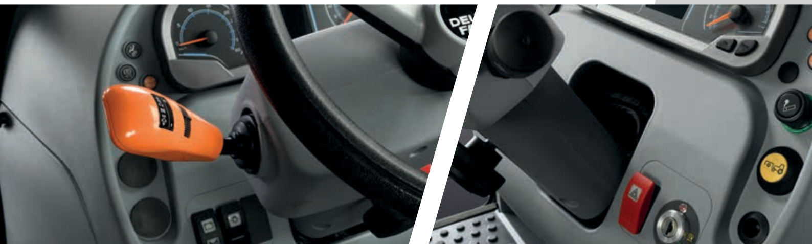
> PowerShuttle met SenseClutch (5 instelbare niveaus).
