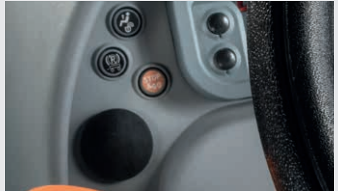
↑ Met de functie Stop&Go kan de bestuurder de tractor stoppen en op zijn plaats houden zonder het koppelingspedaal te gebruiken.
