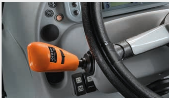
↑ Rewers PowerShuttle ze sprzęgłem SenseClutch (5-stopniowa regulacja).
