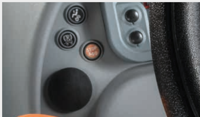
↑ Funkcja Stop&Go umożliwia zatrzymanie i ruszanie bez użycia pedału sprzęgła.
