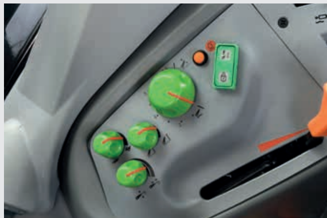
↑ Dostępny elektroniczny podnośnik tylny z tłumieniem drgań.
