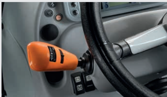
↑ Przekładnia PowerShuttle ze sprzęgłem SenseClutch (5 regulowanych poziomów).
