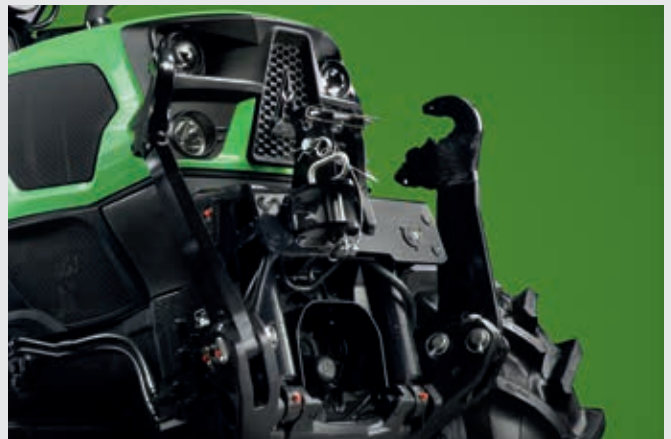
↑ Dostępny podnośnik przedni o udźwigu 2100 kg.
