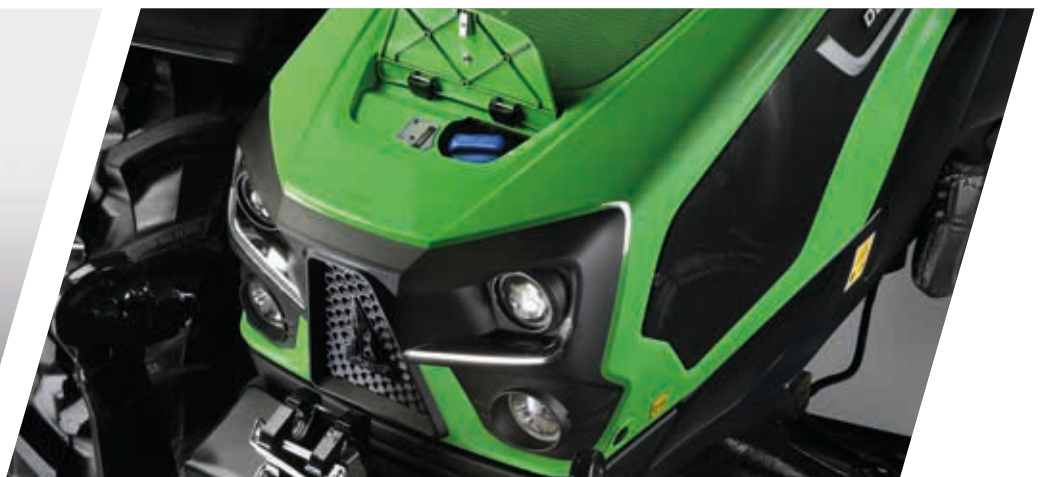
> Depósito de AdBlue facilmente acessível (modelos 5095 D e 5105 D).
