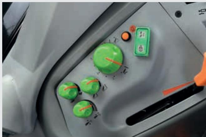
↕ Elevador traseiro eletrónico com a função amortecimento das vibrações disponível.
