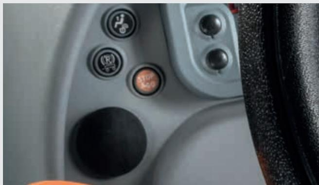
↑ Função Stop&Go permite ao condutor parar e manter o trator parado sem utilizar o pedal da embraiagem.
