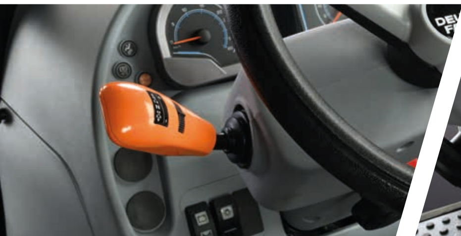
> PowerShuttle mit SenseClutch (5 Einstellstufen).
