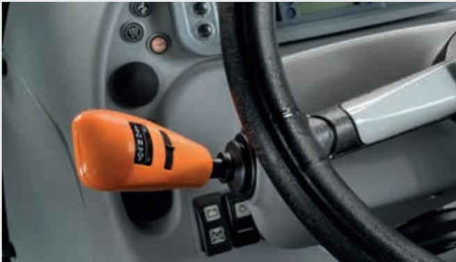
↑ PowerShuttle con inversor regulable SenseClutch (5 niveles de ajuste).
