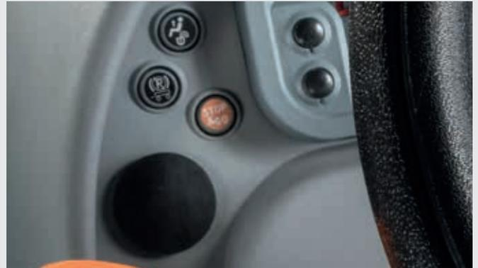
↑ La función Stop&Go permite detener el tractor y retenerlo sin tener que utilizar el pedal del embrague.
