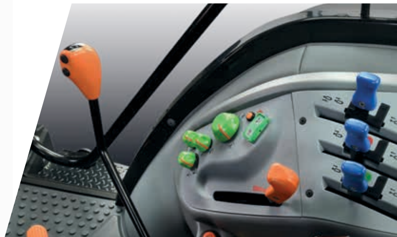
> Relevage arrière électronique avec amortissement des vibrations disponible.
