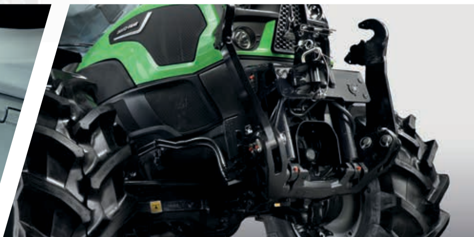
> Relevage avant d'une capacité de 2 100 kg disponible.
