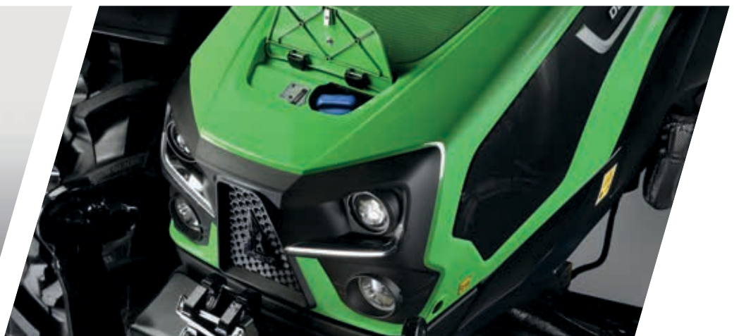
> Réservoir d'AdBlue facile d'accès (modèles 5095 D et 5105 D).
