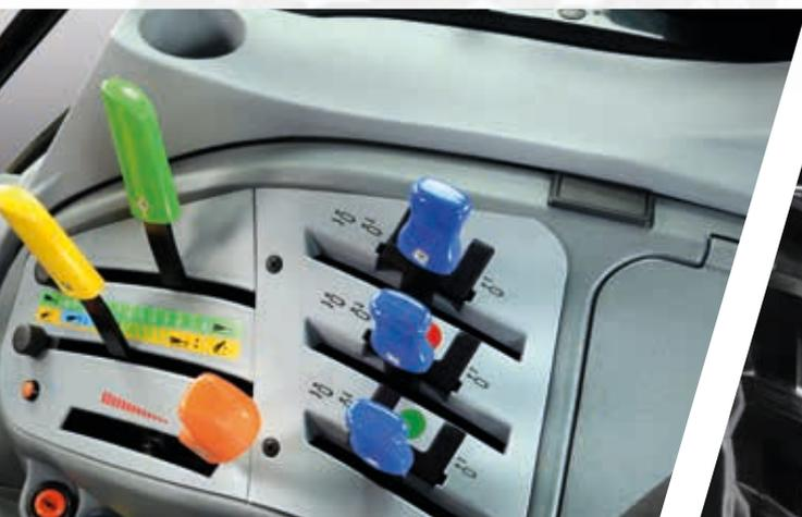
> Commande de relevage arrière mécanique.
