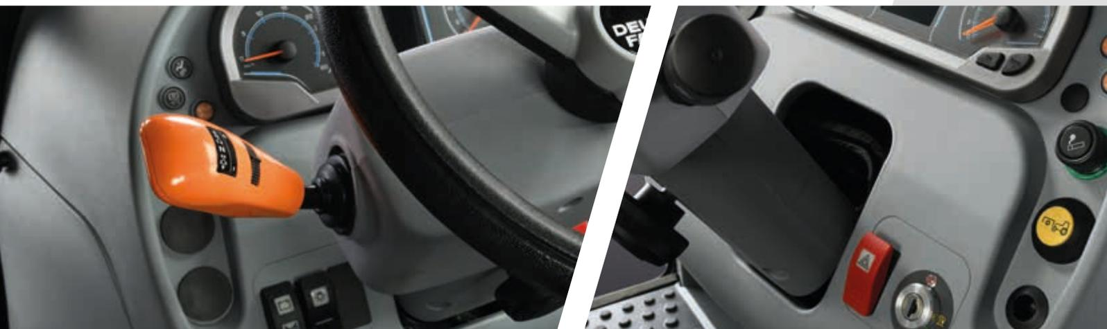
> Inverseur électrohydraulique PowerShuttle avec SenseClutch (5 niveaux réglables).
