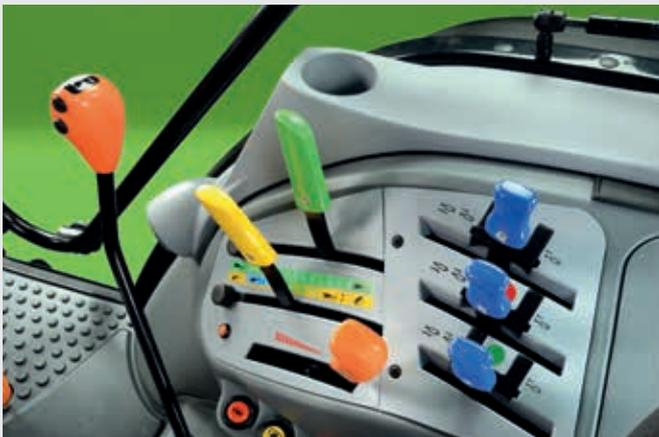
↑ Commande mécanique du relevage arrière.
