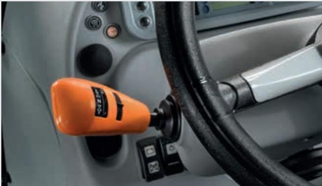
PowerShuttle avec SenseClutch (5 niveaux réglables).
