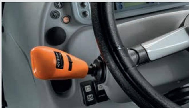
↑ PowerShuttle con SenseClutch (5 livelli regolabili).
