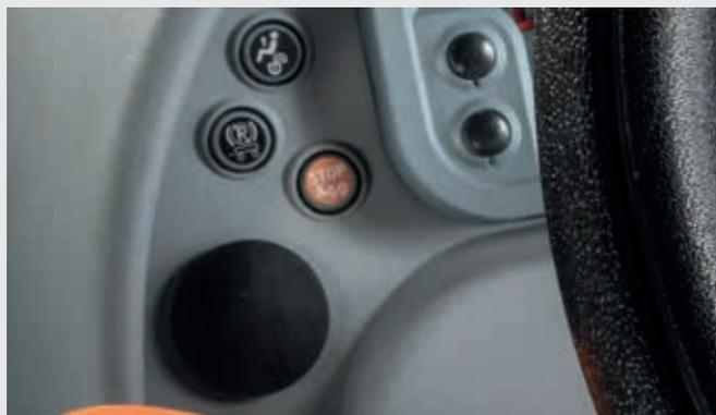
↑ Le funzioni Stop&Go consentono all'operatore di fermare il trattore senza premere il pedale della frizione.
