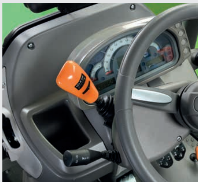
⬆️ PowerShuttle z 5-stopniową regulacją SenseClutch.
