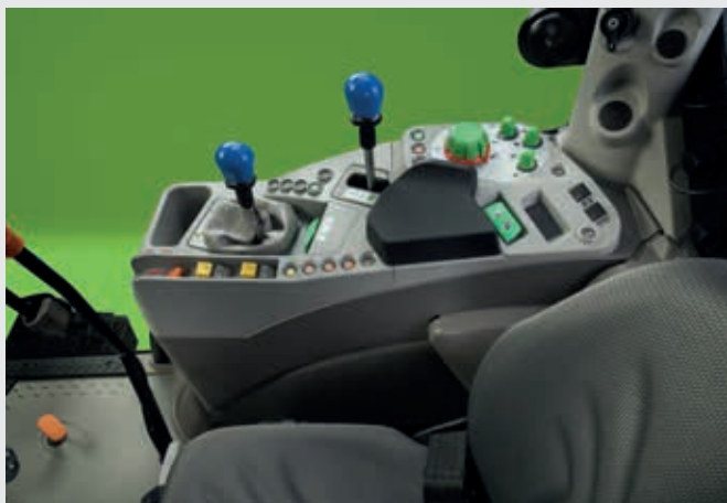
↑ Rozdzielacze tylne sterowane za pomocą pojedynczych dźwigni lub mechanicznych dźwigni krzyżowych.
