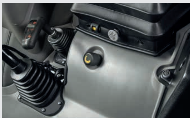
↑ Regulator przepływu w kabinie.
