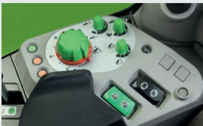
↑ Precyzyjna regulacja siłowa i sterowanie położeniem w elektronicznym tylnym podnośniku.
