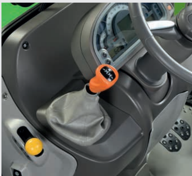
⬆️ Rewers mechaniczny z ergonomiczną dźwignią na kolumnie kierownicy.
