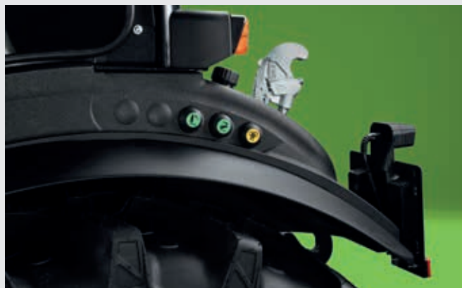
⬆ Zewnętrzne przyciski tylnego podnośnika i WOM ułatwiające sprzęganie maszyn z ciągnikiem.
