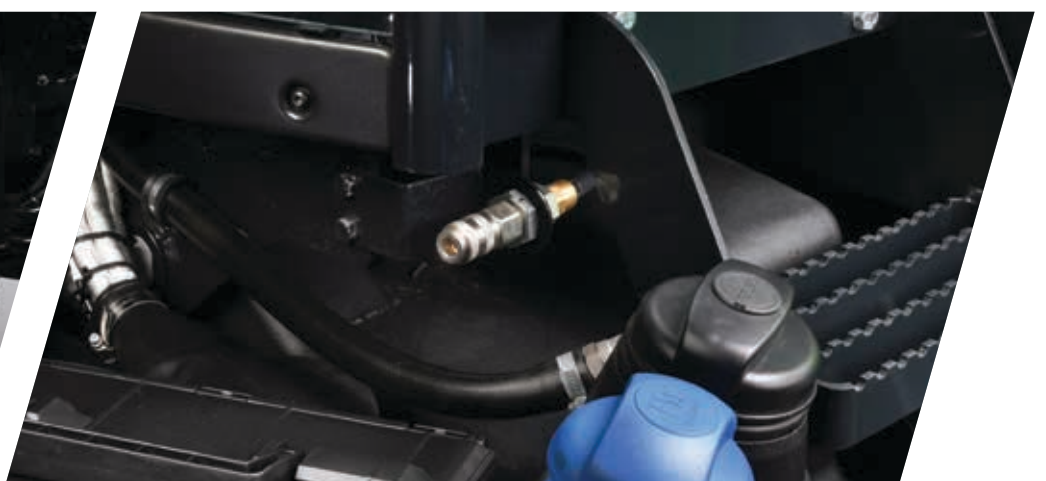
> De optionele persluchtaansluiting bevindt zich direct naast de toegangstreden.
