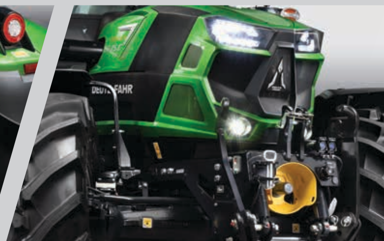
> Optioneel 2 aansluitingen aan de voorkant in combinatie met een frontheadinrichting.
