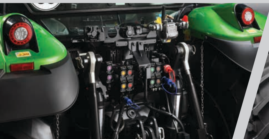
> Tot 10 aansluitingen aan de achterkant naast de Power Beyond-aansluitingen.
