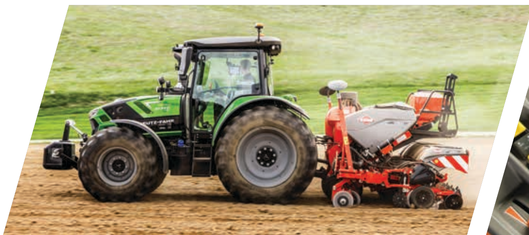
> Nieuwe heffinrichting achter beschikbaar voor modellen RVshift en TTV, met een maximaal hefvermogen van 7100 kg.
