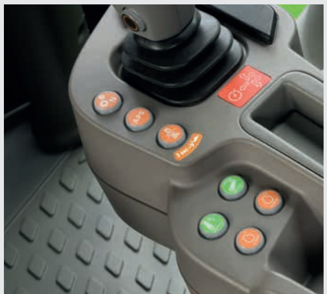
↑ Selectie transport-, akker- en kruipversnellingsmodi.
