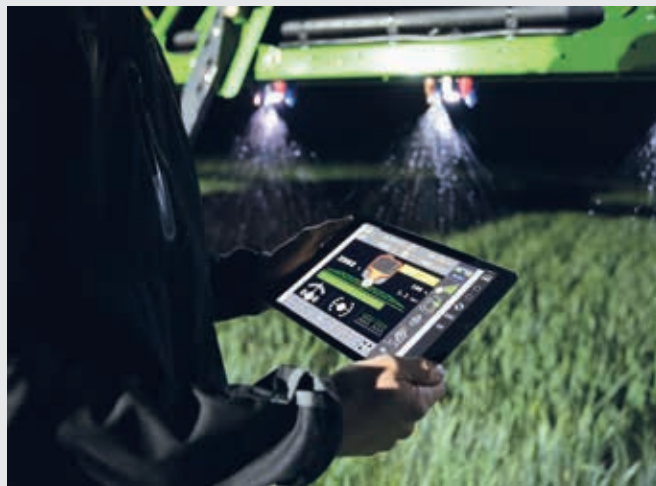
↑ XTEND-functie met tablet, werktuigbediening via ISOBUS UT van buiten de cabine.
