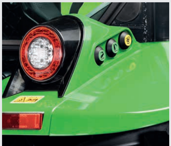
⬆ Externe bedieningsknoppen voor PTO en hefinrichting achter.
