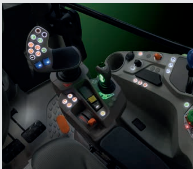
↑ De veelgeprezen MaxCom-joystick waarmee TTV-uitvoeringen zijn uitgerust, is een geconcentreerd pakket van hoogwaardige technologie waarmee de bestuurder alle belangrijke functies van de machine in alle comfort met één hand kan bedienen.
