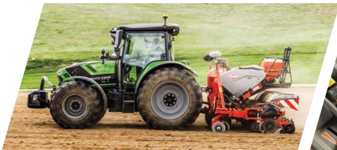
> Nowy podnośnik tylny dostępny dla modeli RVshift i TTV, oferujący maksymalny udźwig 7100 kg.
