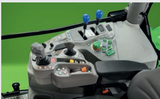
⬆ Mechaniczne i elektroniczne sterowanie hydrauliczne.
