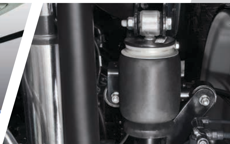
> A nova suspensão pneumática da cabina proporciona um conforto superior em todas as situações.
