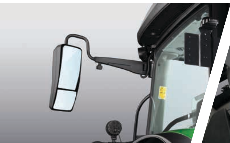
> Espelhos retrovisores XLarge opcionais com regulação elétrica e função de aquecimento
