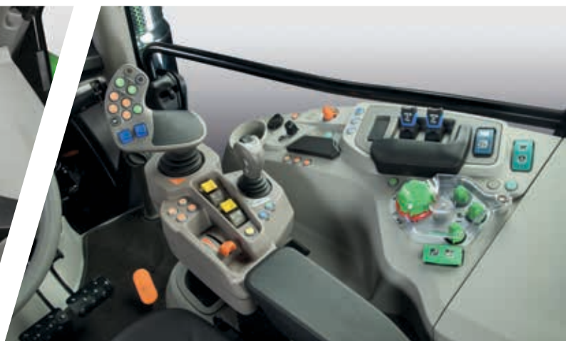
> Configuração de um distribuidor totalmente elétrico em combinação com a transmissão TTV.
