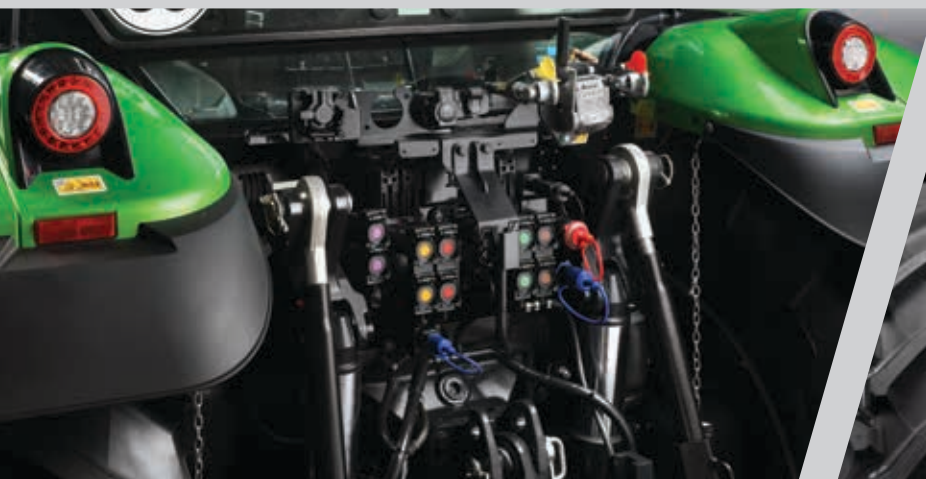
> Até 10 tomadas traseiras, para além dos conectores Power Beyond.
