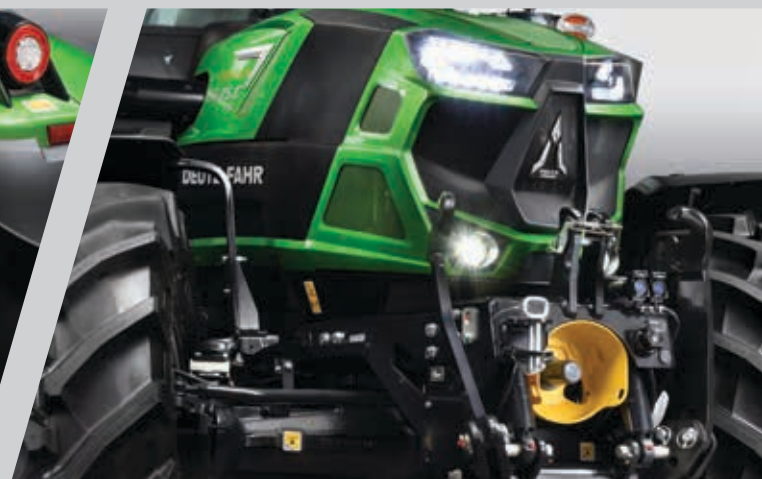
> Opção de 2x saídas dianteiras em combinação com elevador frontal.
