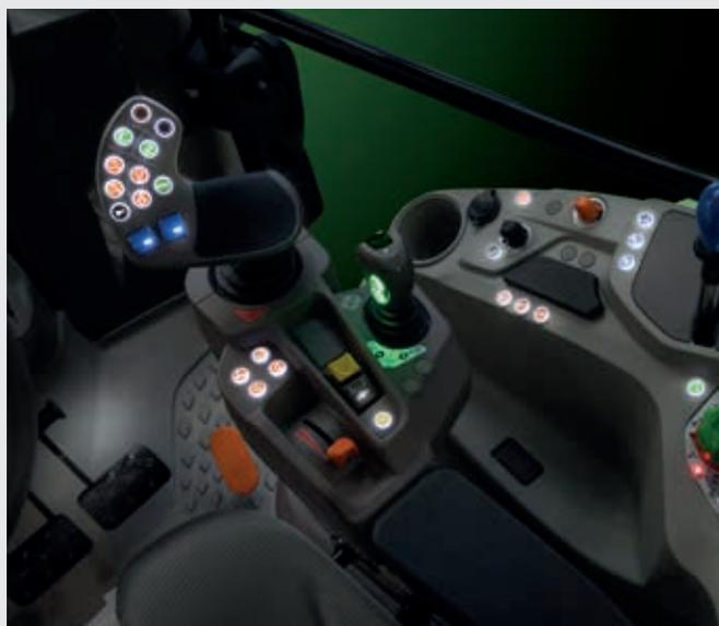
↑ O aclamado joystick MaxCom que equipa as versões TTV é um pacote concentrado de alta tecnologia, que permite ao condutor controlar todas as funções principais da máquina, de forma totalmente confortável e com apenas uma mão.
