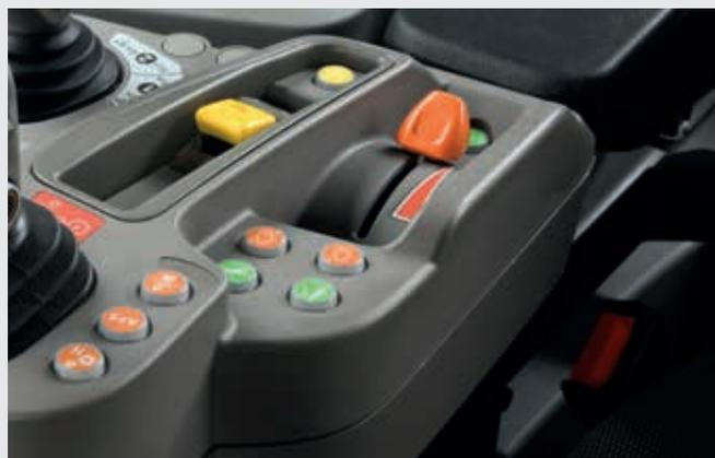
↑ Acelerador manual eletrónico com 2 velocidades de memória do motor.
