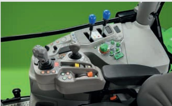
↑ Controlos hidráulicos mecânicos e eletrônicos.
