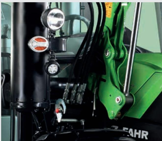
↑ O Light kit é a solução base, que possui unicamente uma estrutura para montagem de qualquer tipo de carregador frontal perfeitamente integrado com o veículo.
