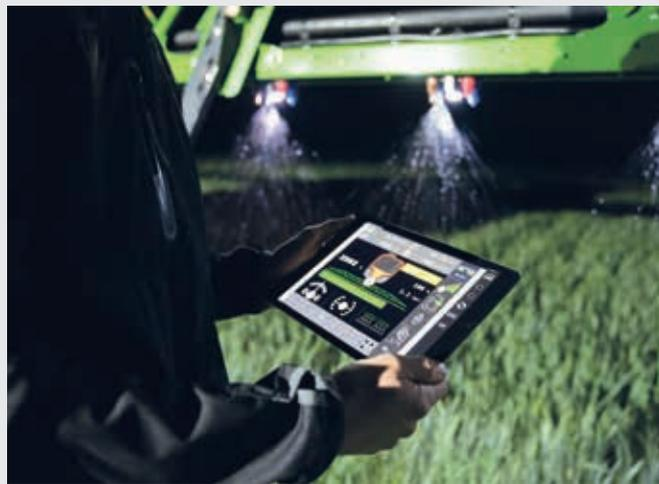
↑ Função XTEND com tablet, controlo de equipamento através do ISOBUS UT quando no exterior da cabina.
