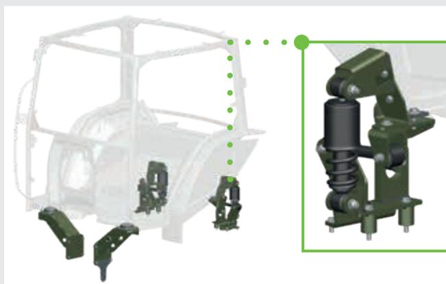
Suspensão mecânica da cabina.
