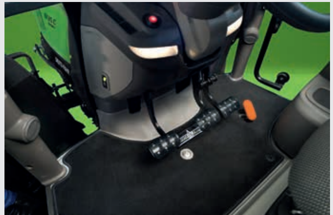
↑ Hydraulische Aktivierung der Motorbremse.
