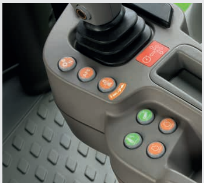
Getriebefunktionen: Fahrmodi (Feld/Transport), APS-Funktion, Kriechgang.
