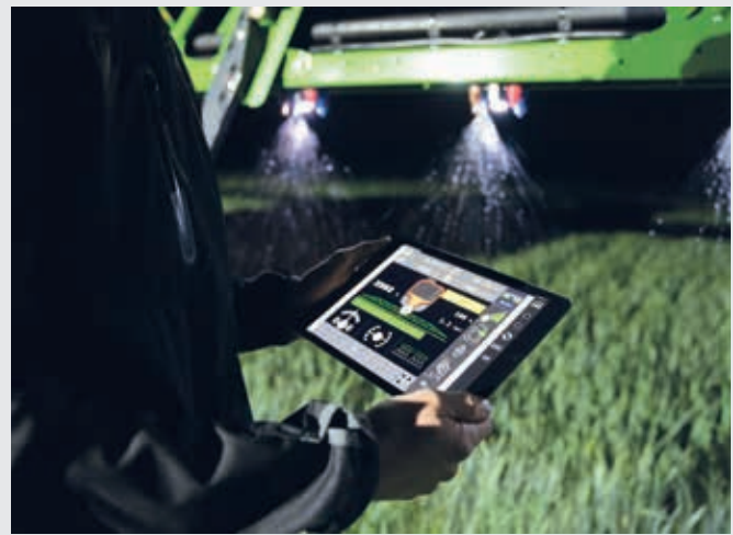
↑ XTEND-Funktion: Die Bedienung von ISOBUS Anbaugeräten über ein Tablet auch außerhalb der Kabine.
