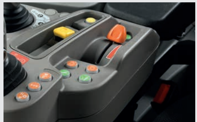
Elektronische Handgasvorrichtung mit zwei speicherbaren Motordrehzahlen.
