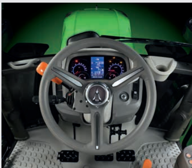
↑ Verstellbares Lenkrad mit InfoCentre Pro
