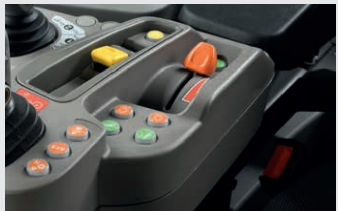
Elektronische Handgasvorrichtung mit zwei speicherbaren Motordrehzahlen.
