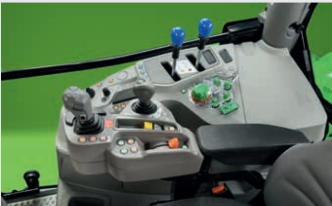
↑ Mechanische und elektrohydraulische Bedienelemente.
