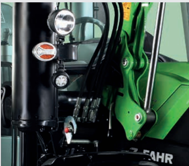
↑ Der Light-Kit ist die Basis für den Frontladeranbau und umfasst die Frontladerkonsolen, welche perfekt integriert sind.
