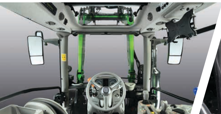
> Escotilla del techo y columna de dirección regulable.
