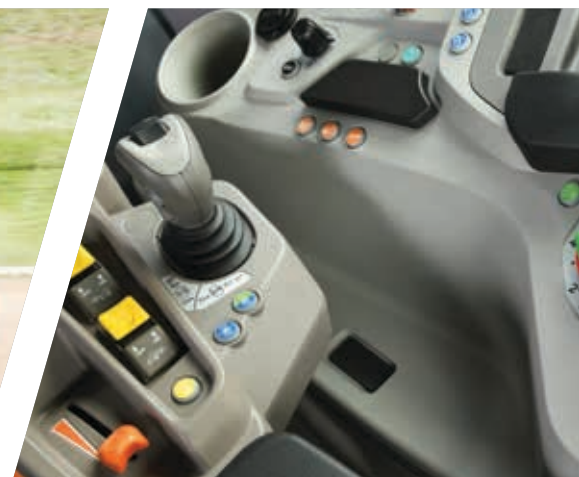
> Botones de activación de la TDF y mandos del elevador trasero.
