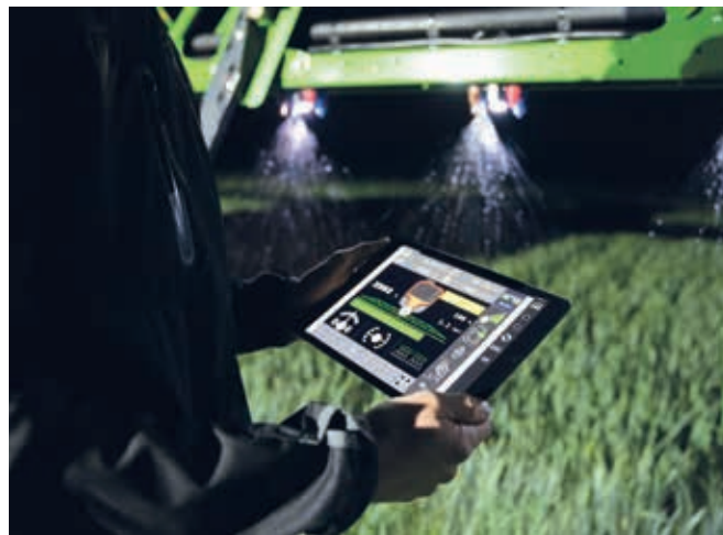
↑ Función XTEND con tableta, control de los implementos mediante ISOBUS. UT estando fuera de la cabina.
