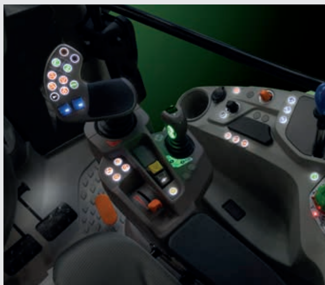
↑ El célebre joystick MaxCom, que equipa las versiones TTV, es un concentrado de alta tecnología que te permite controlar las funciones principales del tractor con total comodidad y con una sola mano.
