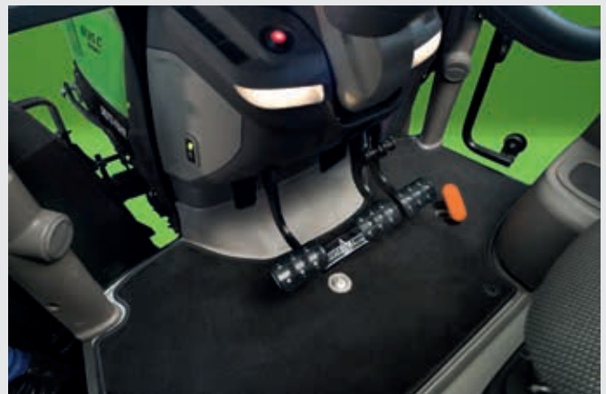
Activación de freno motor hidráulico.
