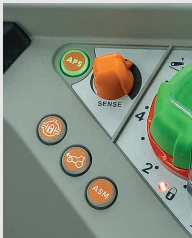
↑ Activación de APS con respuesta ajustable.
