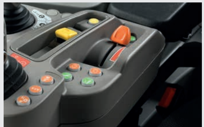
Acilador electrónico de mano con 2 memorias de régimen del motor.
