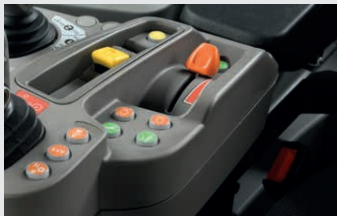
Accélérateur manuel électronique avec 2 régimes de mémorisation moteur.
