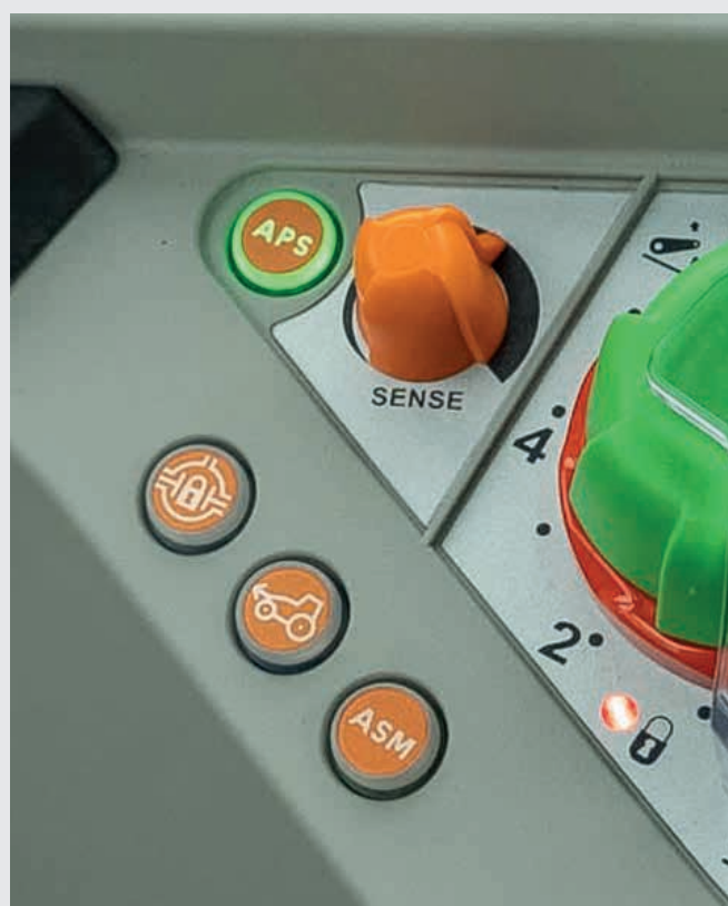
↑ Activation APS avec réglage de sa réactivité.
