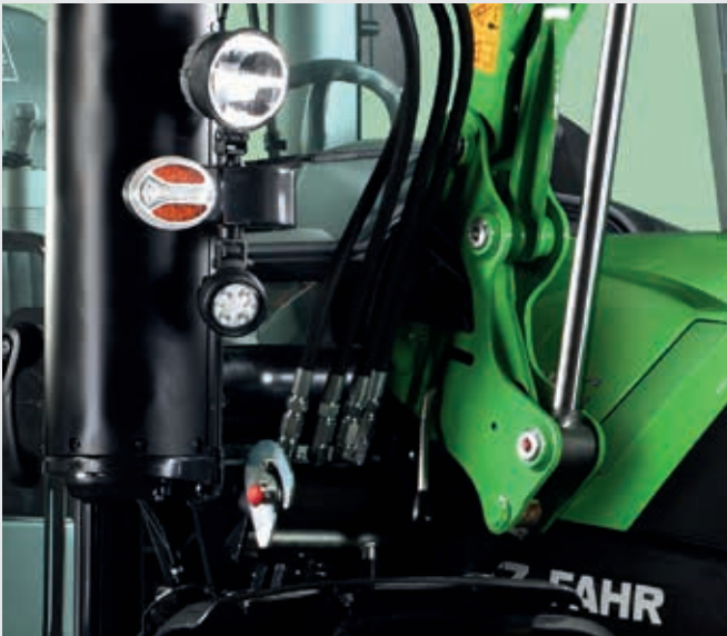
↑ Light kiti, araç ile mükemmel şekilde entegre edilen herhangi bir tipte ön yükleyicinin montajı için basitçe bir çerçeve içeren temel çözümdür.
