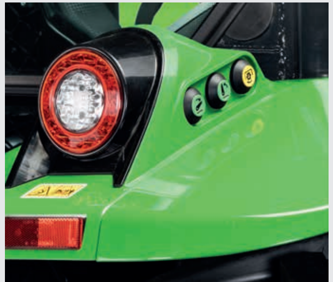
Arka kaldırıcı ve PTO için harici kontroller.
