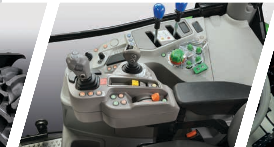
> Configurazione idraulica mista con 2 valvole meccaniche e 2 elettroniche abbinata alla trasmissione RVshift.
