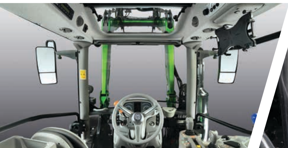
> Tettuccio sollevabile e piantone sterzo regolabile.
