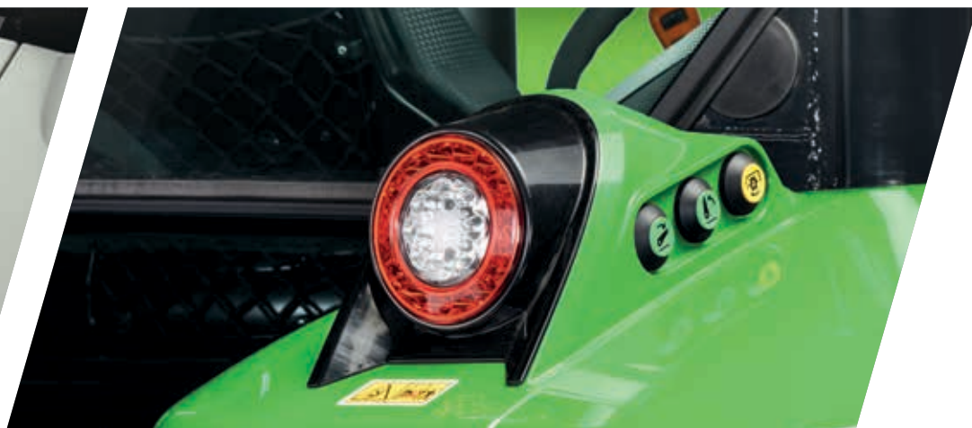
> Comandi esterni per PTO e sollevatore posteriore.
