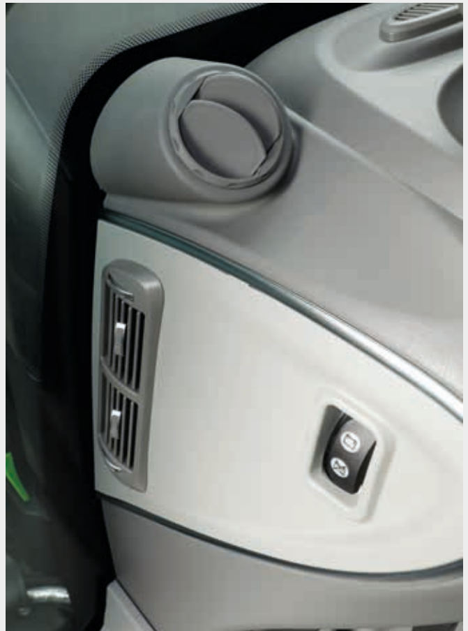
📌 Nieuwe aanpasbare luchtuitlaten, en de accuschakelaar is op een handige plek links naast de stuurkolom geplaatst.
