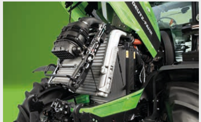
⬆️ Aluminium koelsysteem van 6210 TTV, 6230 TTV en 6230 TTV HD met een met één hand te bedienen toegangshendel en Powercore-luchtfilter.
