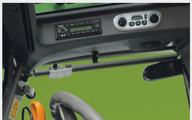
📌 Bediening voor radio, airco en lichten, alsook een verschuivende monitorrail.
