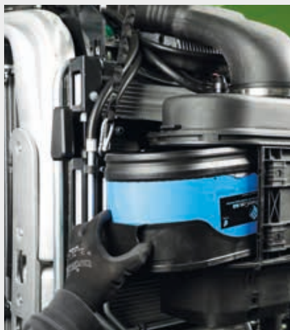
↑ Luchtfilter met voorreinigingssysteem.
