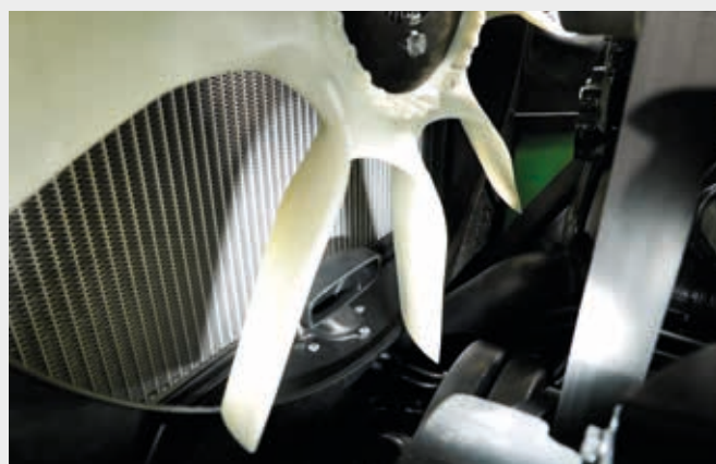
↑ Elektronische viscostatische ventilator (eVisco) met vacuümslang voor het vooraf reinigende systeem van de luchtfilter (verwijdt 95% van de grove deeltjes voordat ze de luchtfilters bereiken).
