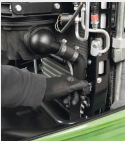
↑ Koelpakket met eenvoudig openingsmechanisme.
