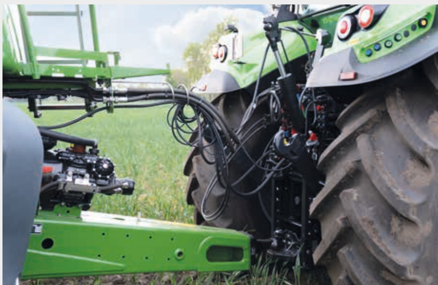
⬆ Heflatten achter in transportstand zodat die niet in contact komt met de dissel in bochten.
