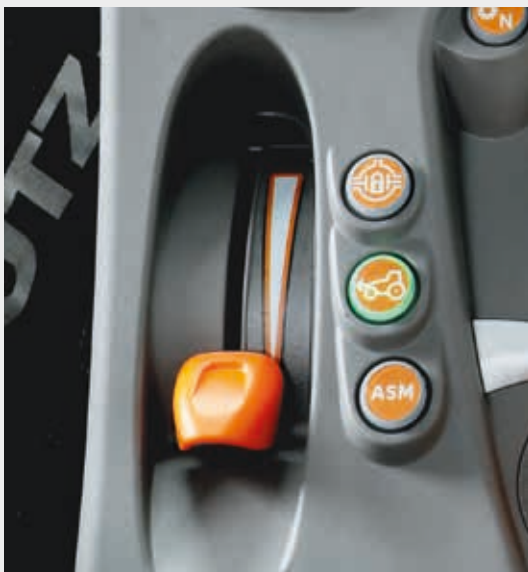
Onafhankelijk handgas en elektrohydraulische activering van de differentieelblokkering, vierwielaandrijving en ASM-functie.
