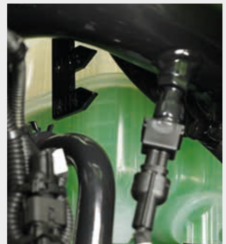
↑ Koelvloeistofreservoir met stalen vloeistofpeil-indicator.
