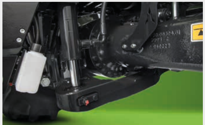
↑ Vooras van 6190 TTV met een stevige onderste zwenkarm.
