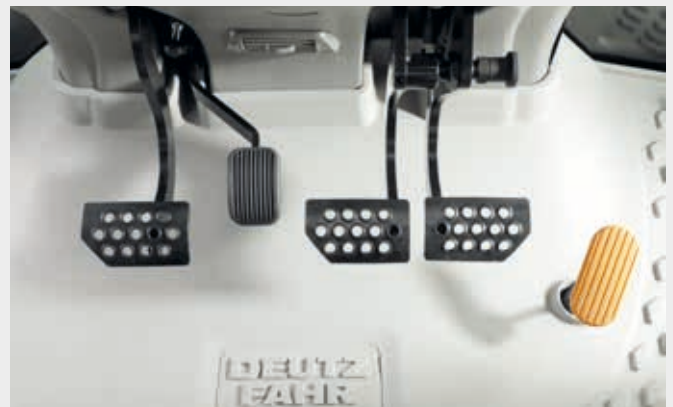
⬆️ Pedalen met Engine brake PLUS (Pedaal tussen koppeling en rempedalen).
