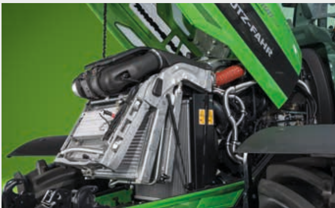
⬆️ Aluminium koelsysteem van 6190 TTV met een met één hand te bedienen toegangshendel en Powercore-luchtfilter..
