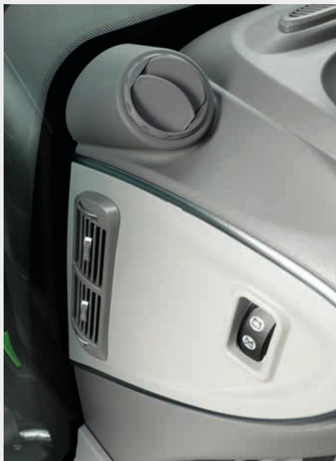
Novas saídas de ar ajustáveis e o interruptor da bateria estrategicamente localizado na coluna de direção esquerda.
