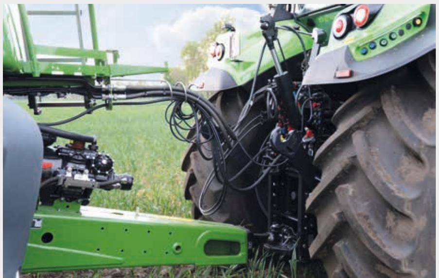
↑ Elevador traseiro na posição de transporte para ausência de interferência com as barras de reboque nas viragens.
