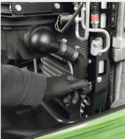
↑ Pacote de refrigeração com mecanismo de abertura fácil.
