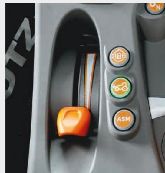
↑ Acelerador manual independente e ativação eletro-hidráulica do bloqueio dos diferenciais, da dupla tração e da função ASM.
