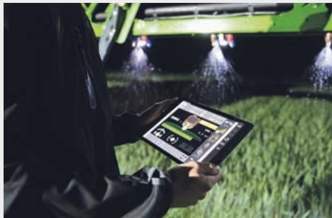
↑ Função XTEND, controlo de equipamento através do ISOBUS UT via tablet quando no exterior da cabina.
