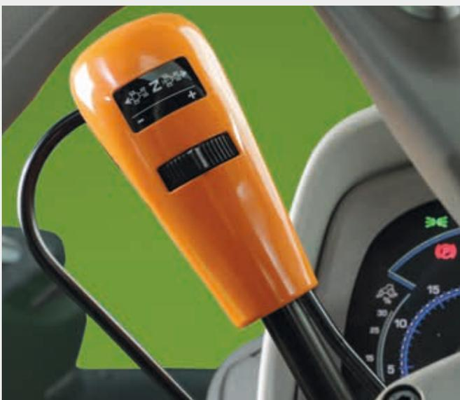
↑ PowerShuttle com SenseClutch e cinco níveis de regulação.
