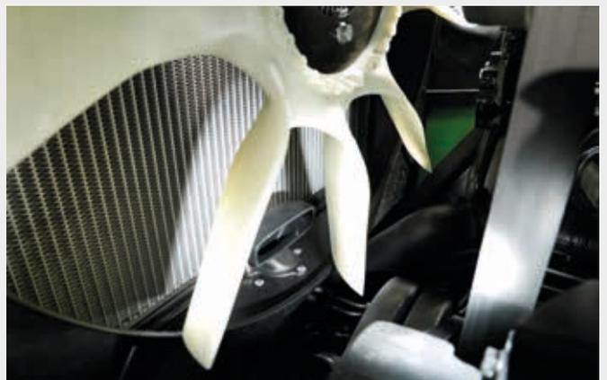
Ventoinha viscoestática eletrônica (eVisco) com tubo de sucção para o sistema de pré-limpeza do filtro de ar (remove 95% das partículas grosseiras antes de elas chegarem aos filtros).
