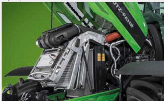
↑ Sistema de refrigeração em alumínio do 6190 TTV com alavanca de acesso a uma mão e filtro de ar Powercore.
