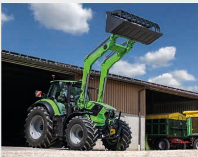
↑ Altura de elevação máxima de 4,5 m e uma força de arranque de 3770 daN.
