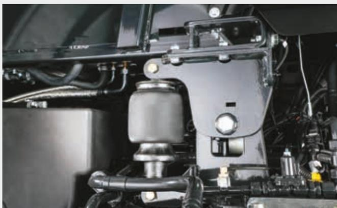
↑ Elementos de mola de ar da suspensão pneumática confortável da cabina.
