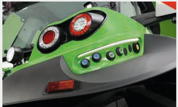
↑ Botões iluminados para comando externo do elevador traseiro, da TDF e de uma válvula de bobina.
