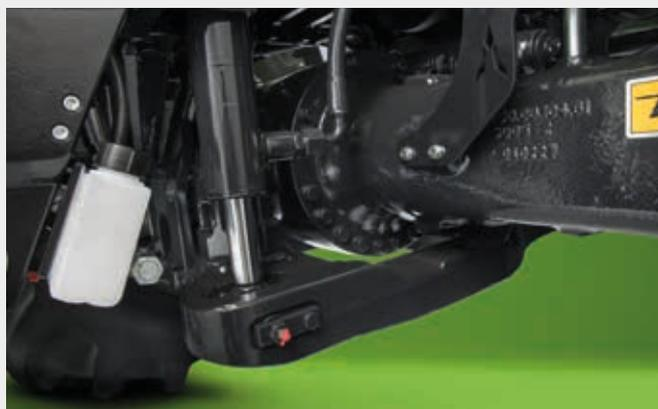
↑ Eixo dianteiro do 6190 TTV com braço oscilante inferior robusto.
