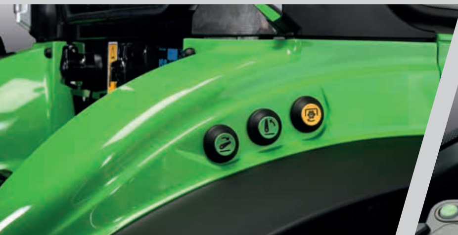
> Externe bediening van aftakas en hefinrichting achter op linker en rechter spatbord.
