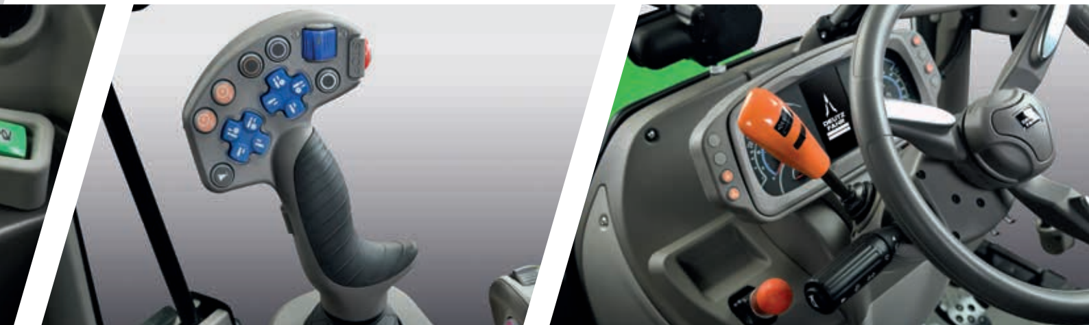
> MaxCom-joystick voor eenvoudige regeling van de rijnsnelheid.
