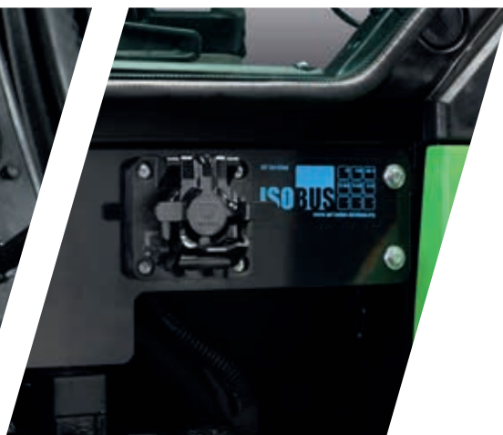
> ISOBUS: kunt u elk type werktuig aansluiten en gebruik maken van diverse ISOBUS-functies.
