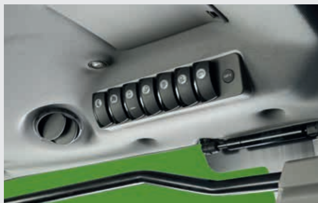
↑ Bescherming tegen aerosolen van pesticiden door Cat.4 filtratie, eenvoudig in te schakelen met een knop.
