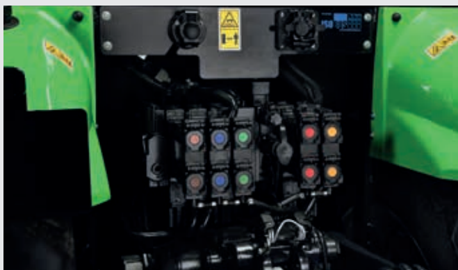
↑ Tot 5 elektronisch gestuurde hydrauliekventielen achter.
