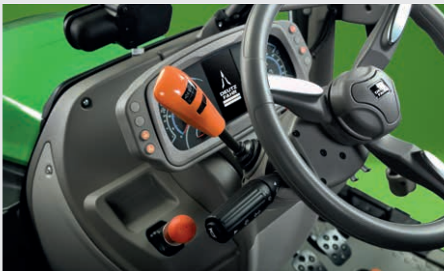
PowerShuttle met SenseClutch (5 instelbare niveaus).
