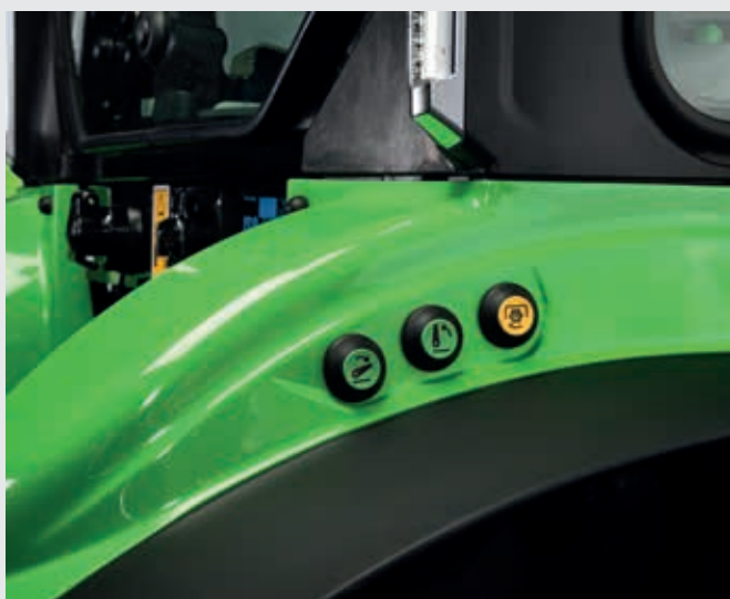
↑ Externe bediening van aftakas en hefinrichting achter op linker en rechter spatbord.
