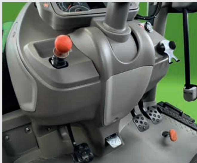
↑ Standaard uitgerust met vierwielberemming en hydraulische parkeerrem (HPB).
