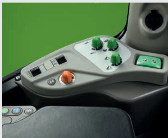
↑ De bestuurder kan kiezen uit meerde standen voor motormanagement, van "ECO" tot "Power" voor maximaal vermogen.
