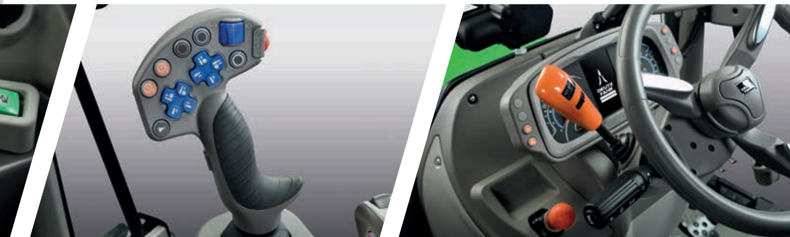
> Joystick MaxCom para permitir uma gestão simples da velocidade de condução.
