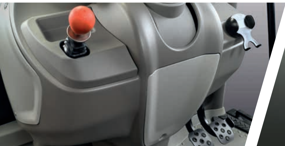
> Equipado com travagem integral e travão de estacionamento hidráulico (HPB) de série.
