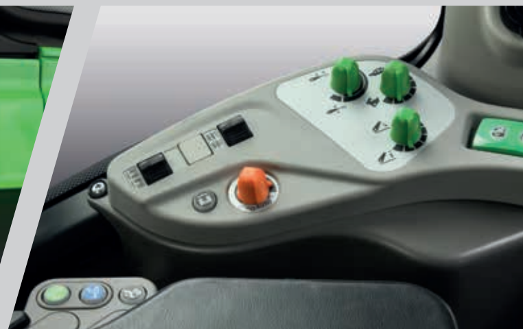
> O condutor pode seleccionar uma gama de modos de gestão do motor "ECO" a "Power", para máxima potência.
