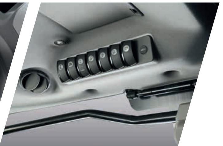
> A proteção contra aerossóis pesticidas, conseguida pela filtragem de cat. 4, pode ser ativada facilmente através de um botão.
