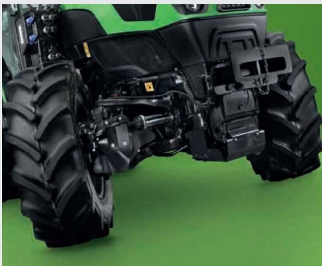
↑ Grande manobrabilidade graças ao ângulo de viragem elevado, assegurado pela suspensão independente do eixo dianteiro.
