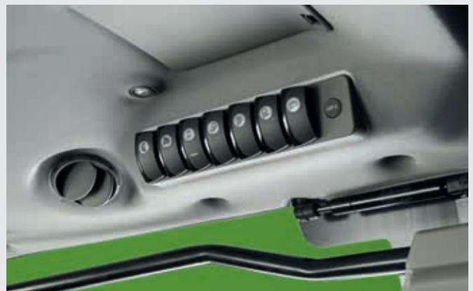
↑ A proteção contra aerossóis pesticidas, conseguida pela filtragem de cat. 4, pode ser ativada facilmente através de um botão.
