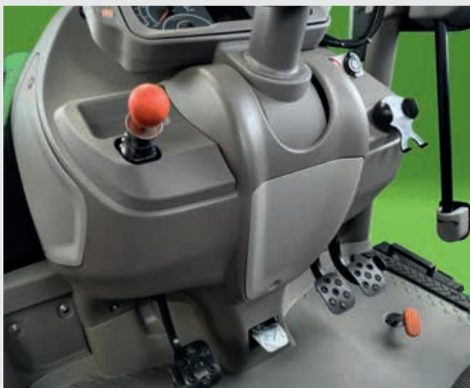
↑ Equipado com travagem integral e travão de estacionamento hidráulico (HPB) de série.
