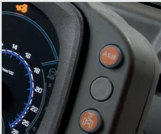
↑ A função ASM ativa e desativa automaticamente a tração dupla e o bloqueio do diferencial de acordo com o ângulo de viragem e a velocidade de avanço, permitindo que o condutor se concentre durante as manobras na cabeceira.
