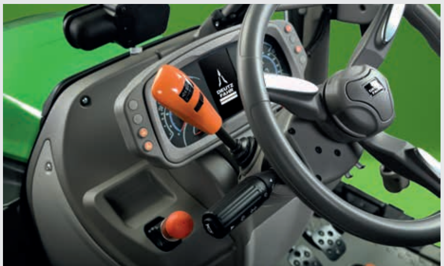
↑ PowerShuttle mit SenseClutch (5 Einstellstufen für das Ansprechverhalten).
