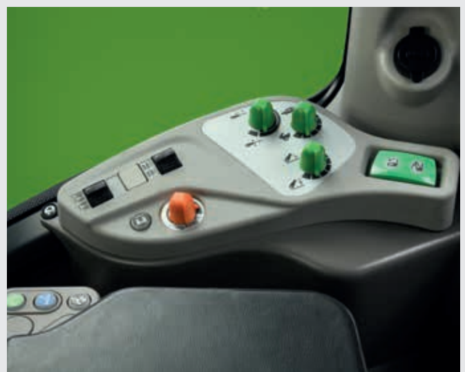
↑ Der Fahrer kann per Drehpoti selbst das Motormanagement von „Eco“ bis „Power“ für maximale Leistung einstellen.
