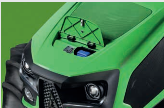
⬆ Leicht erreichbarer AdBlue-Tank.
