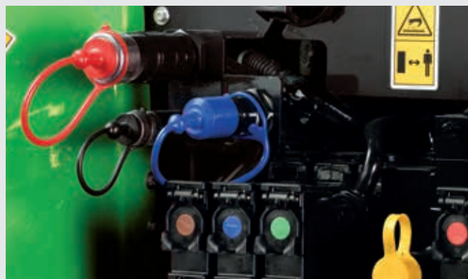
↑ PowerBeyond-Anschlüsse im Heck verfügbar.
