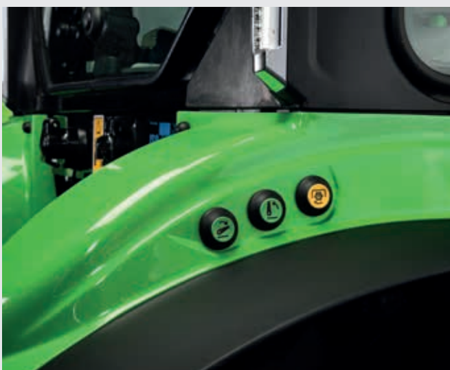
↑ Externe Bedienung für Zapfwelle und Heckkraftheber am linken und rechten Kotflügel.
