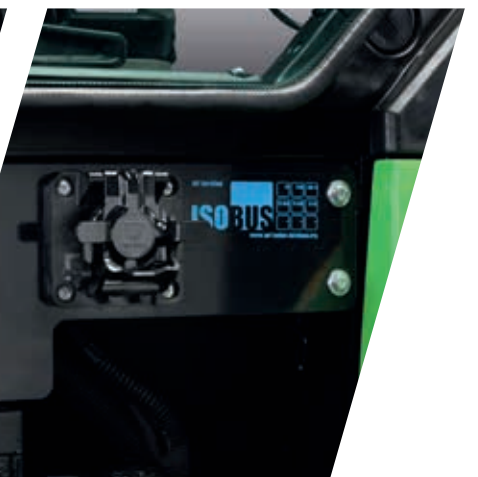
> ISOBUS: puedes conectar cualquier tipo de implemento y utilizar diferentes funciones ISOBUS.
