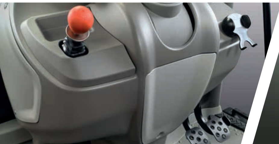
> Equipado de serie con frenos en las cuatro ruedas y freno de estacionamiento hidráulico (HPB).
