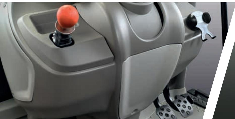
> Equipado de serie con frenos en las cuatro ruedas y freno de estacionamiento hidráulico (HPB).
