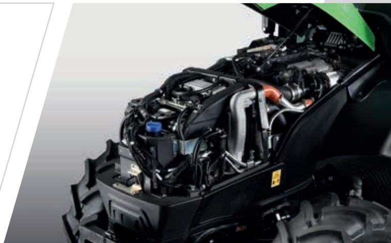
> Gracias a la gestión de potencia activa (función OverBoost), los modelos 5115 DF/DS/DV TTV ganan 10 CV para ofrecer una potencia máxima de 126 CV.
