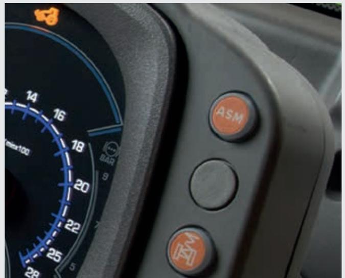
↑ La función ASM activa y desactiva automáticamente la doble tracción y el bloqueo del diferencial en función del ángulo de giro y la velocidad, para que puedas concentrarte mejor en las maniobras de las cabeceras.
