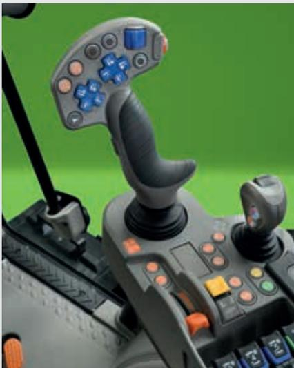
↑ Con el joystick MaxCom se gestiona fácilmente la velocidad de conducción.
