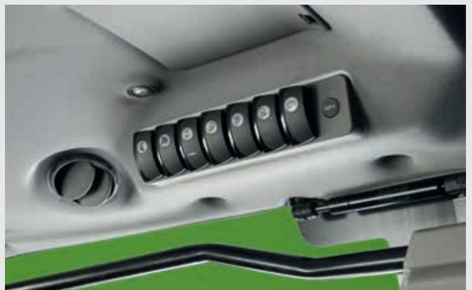
La protección contra los aerosoles de pesticidas, que garantiza la filtración Cat.4, se puede activar fácilmente mediante un botón.
