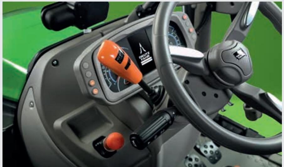
↑ Inversor electrohidráulico regulable (SenseClutch) con 5 niveles de ajuste.
