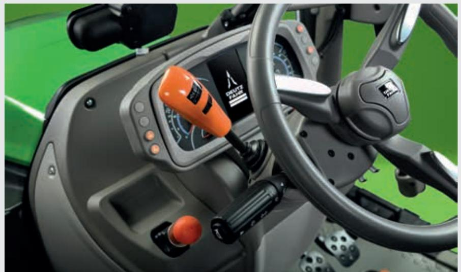
↑ Inverseur avec SenseClutch (5 niveaux réglables).
