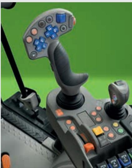
↑ Joystick MaxCom permettant de gérer facilement la vitesse de conduite.
