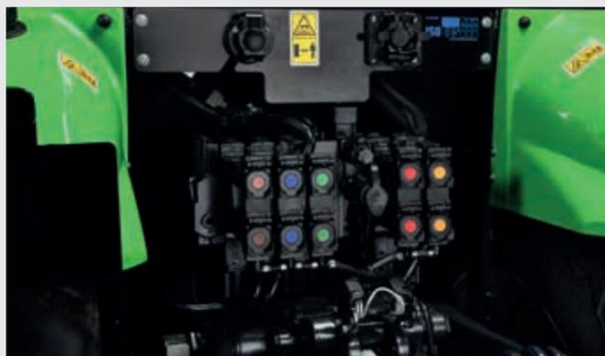
↑ Jusqu'à 5 distributeurs arrière à commande électronique.
