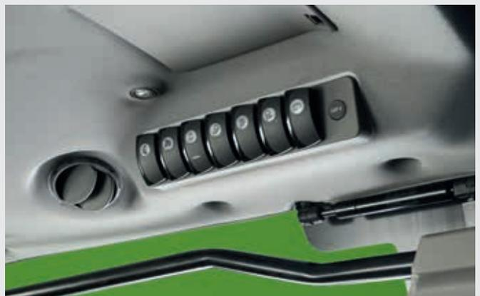
↑ La protection contre les aérosols de pesticides, assurée par une filtration de catégorie 4, peut être facilement activée par un bouton.
