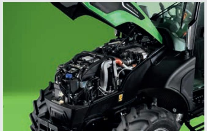
↑ Grâce à la gestion de la puissance OverBoost, les modèles 5115 DF DS DV TTV gagnent 10 Ch supplémentaires, pour atteindre une puissance maximale de 126 Ch.
