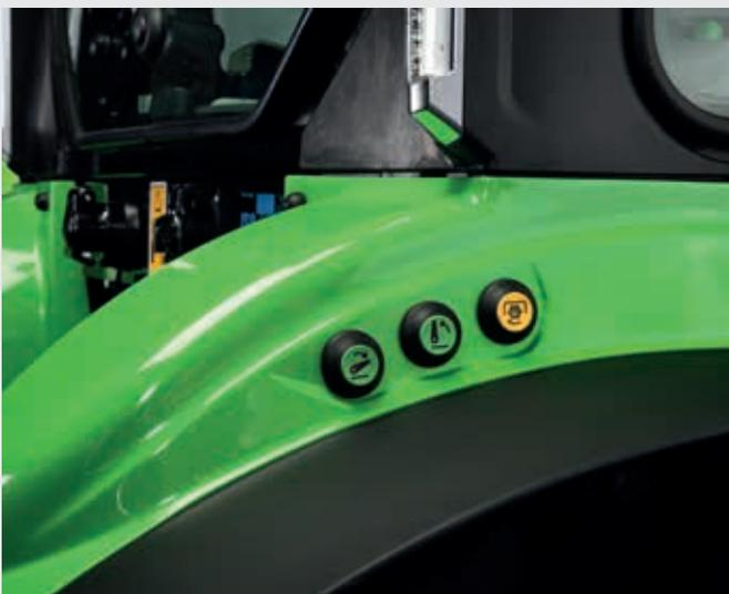
↑ Boutons externes de prise de force et de relevage arrière sur les ailes gauche et droite.
