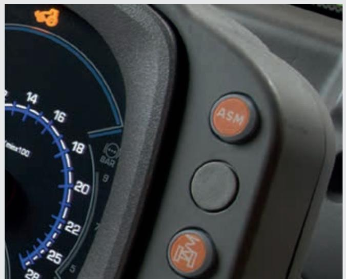
↑ La fonction ASM active et désactive automatiquement les 4 roues motrices et le blocage du différentiel en fonction de l'angle de braquage et de la vitesse d'avancement, ce qui permet au conducteur de rester concentré lors des manœuvres en bout de champ.
