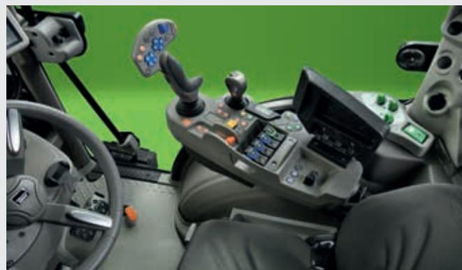
↑ Distributeurs arrière et ventraux faciles à utiliser grâce aux contrôles proportionnels. Les commandes sont librement attribuables via les paramètres InfoCentre<sup>Pro</sup>.
