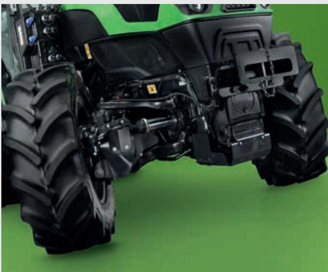
↑ Grande maniabilité grâce à un angle de braquage élevé assuré par la suspension indépendante du pont avant.
